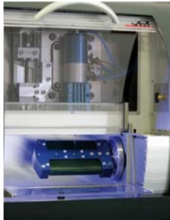
Рабочая зона со шпинделем высокой частоты (скорость вращения до 60.000 об/мин) при открытой передней дверце
