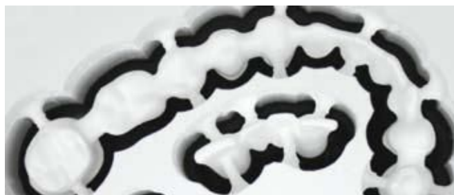
Детальное представление вершины циркониевой заготовки - Вы можете фрезеровать мосты, одновременно работая с четырнадцатью единицами.
