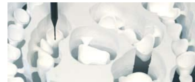
Детальное представление нижней стороны циркониевой заготовки – механическая обработка со специальной сферической фрезой.
